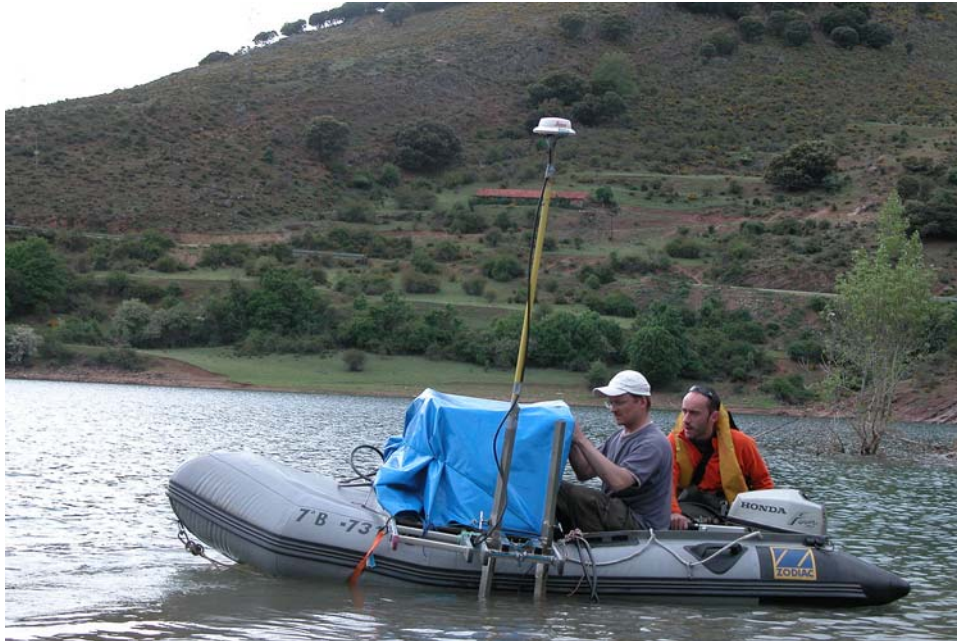
Figura 4: Aspecto de la instalación de la ecosonda y del GPS.
